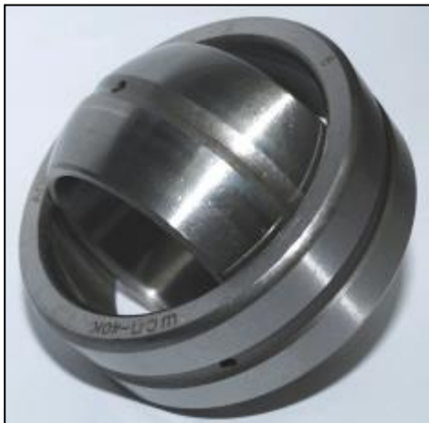
Підвіска балансиру на підшипниках «ШС»
