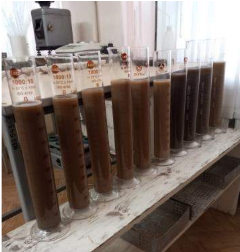
Рис. 5.15 – Процес визначення гранулометричного складу ґрунтів у лабораторії методом піпетки
